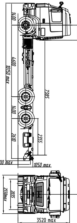
**ТЕХНИЧЕСКИЕ ХАРАКТЕРИСТИКИ***Технически допустимая масса автопоезда, кг.....53000**Технически допустимая общая масса автомобиля, кг.....26500**Распределение технически допустимой общей массы автомобиля:
