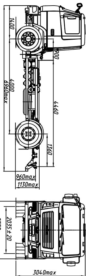
**ТЕХНИЧЕСКИЕ ХАРАКТЕРИСТИКИ****Технически допустимая общая масса автомобиля, кг.....19000****Распределение технически допустимой общей массы автомобиля:
